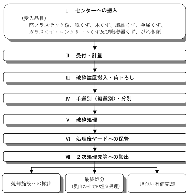
図1-3-10 廃棄物の処理工程（破碎処理施設）
